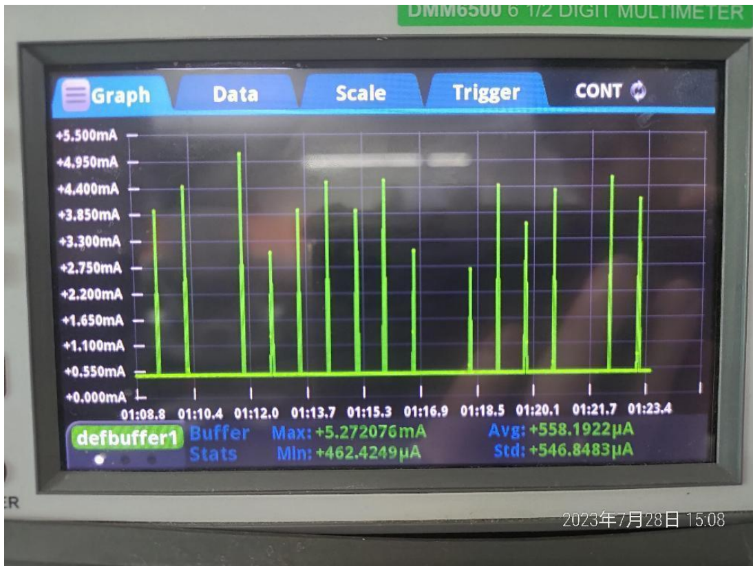
图 7 使能低功耗休眠状态下的工作电流图示
