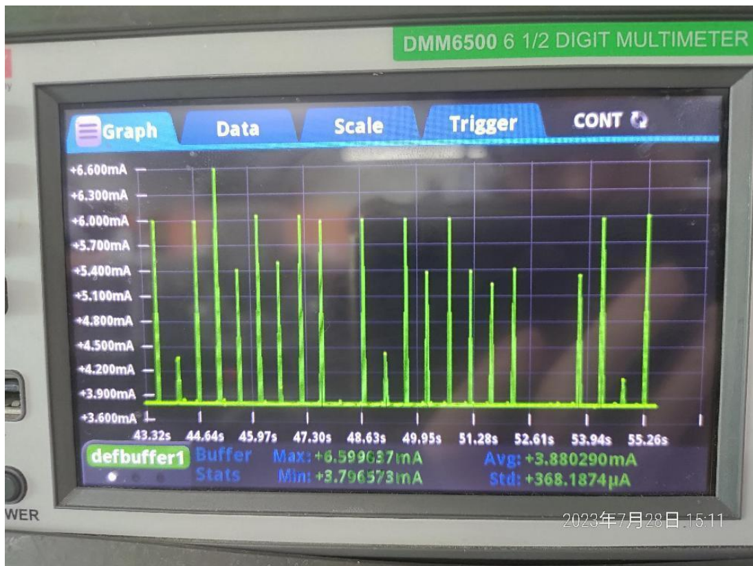
图 7 使能低功耗休眠状态下的工作电流图示
